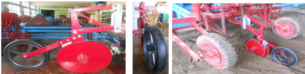
Рис. 4. Двухдисковый сошник с опорно-прикатывающим каточком фирмы Lemken: □ –1 5 ,2 1 ,3 1 ,4 4 ,5 1 ,6 3 ,7 2 ,8 1 ,9 7 ,10 8 ,11 8 ,12 8 ,13 3 ,14 3 ,15 8 ,16 3 ,17 6 ,18 5 ,19 2 ,20 6 ,21 1 ,22 3 ,23 6
