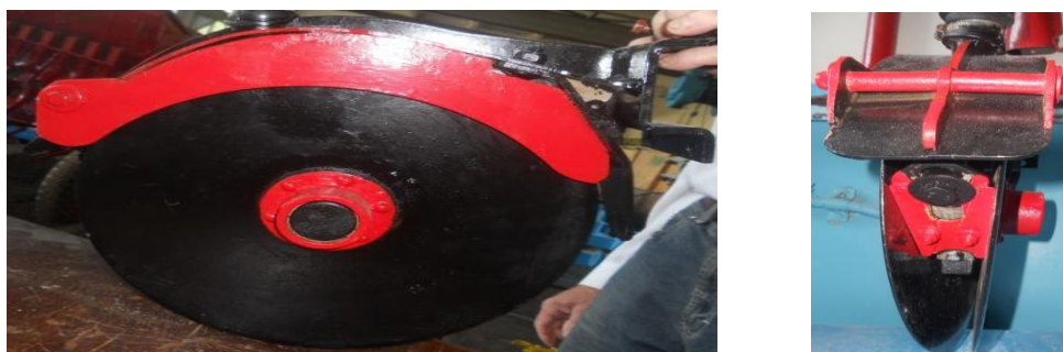
Рис. 2. Двухдисковый сошник рядового посева с углом атаки дисков \alpha=9^\circ фирмы Rabe: ■ – 1 1 , 2 1 , 3 1 , 4 5 , 5 1 , 6 3 , 7 2 , 8 3 , 9 7 , 10 8 , 11 9 , 12 3 , 13 2 , 14 7 , 15 8 , 16 3 , 17 7 , 18 5 , 19 3 , 20 2 , 21 1 , 22 3 , 23 1
