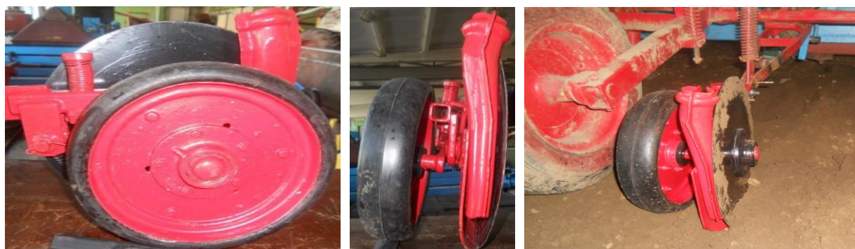
Рис. 3. Однодисковый сошник с опорно-прикатывающим каточком и устройством для изменения глубины высева семян: (•)–1 2 , 2 2 , 3 8 , 4 5 , 5 1 , 6 3 , 7 2 , 8 5 , 9 6 , 10 8 , 11 2 , 12 3 , 13 3 , 14 4 , 15 8 , 16 2 , 17 1 , 18 5 , 19 3 , 20 6 , 21 9 , 22 3 , 23 1
