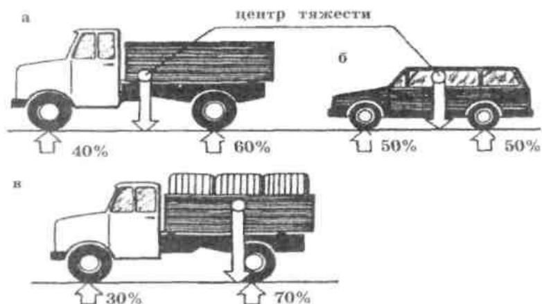
Рис. 1.5. Распределение массы транспортного средства по осям
