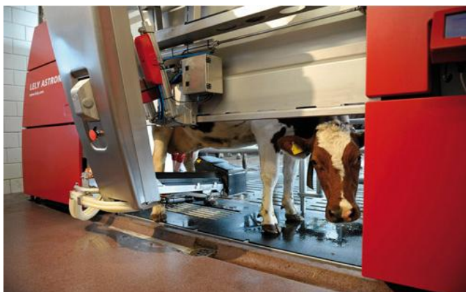
Рис. 201. Доильный робот «Астронавт» фирмы «Lely»
