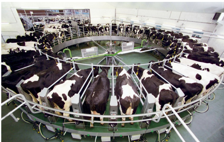
Рис. 196. Доильная установка «Карусель»
