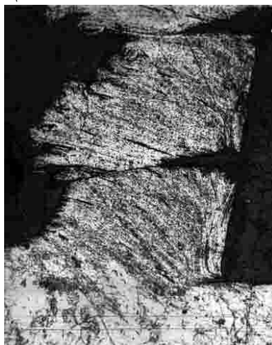
Рис. 2.37. Микрофотография корня стружки скалывания, полученного при точении стали 12Х18Н10Т.
