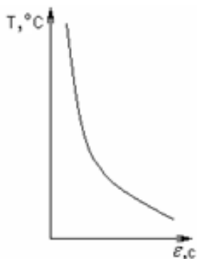
Рис. 3. Кривая охлаждения аморфного вещества.
