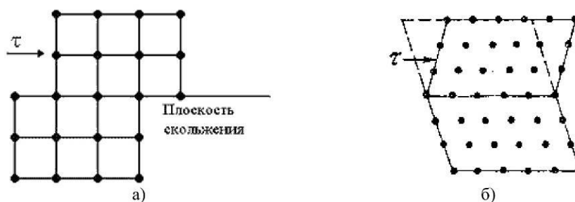
Рис. 1.29. Схемы пластической деформации различными способами: а – скольжением; б – двойникованием
