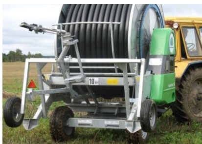
Рис. 5.4. Внешний вид шлангового дождевателя
