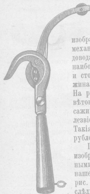
Рис. 18. Ножницы для срезанія высокорасположенныхъ сучьевъ.
