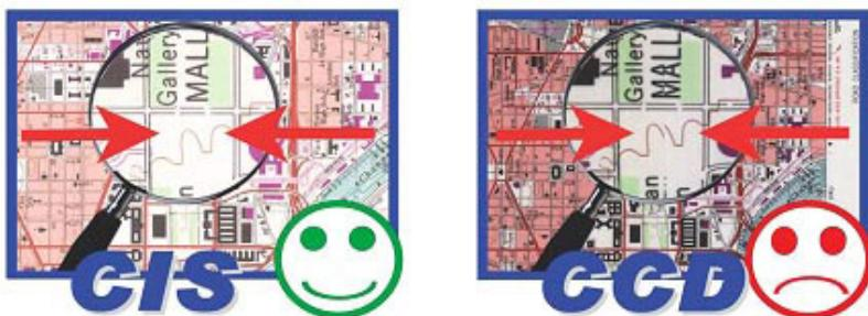
Рис. 7.78. Изображение в местах стыковки соседних CCD-камер
