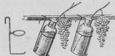
Рис. 60. Укрѣпленіе склянокъ къ перекладинамъ стойки, изображенной на предыдущемъ рисункѣ 59.
