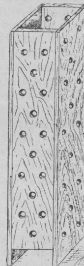
Рис. 76. Деревянная труба съ отверстіями.
