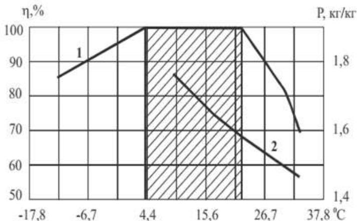
Рис. 1. Влияние температуры окружающей среды на удои в % к нормальной продуктивности (1) и на расход условного корма (2)
