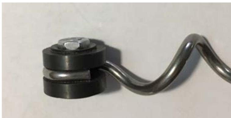
Рис. 3. Устройство роторного магнитного смесителя (РМС)
