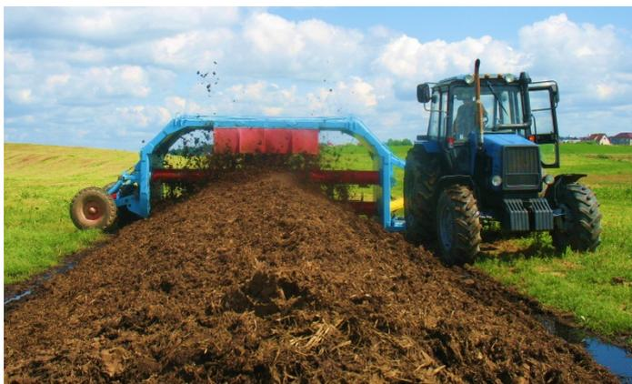
Рис. 2.2. Аэратор-смеситель АСК-3,5 в работе
