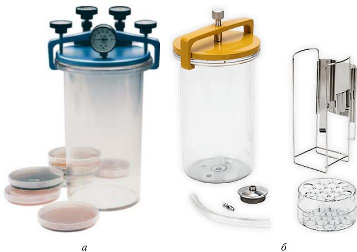
Рис. 7.1. Приборы для культивирования анаэробов:
