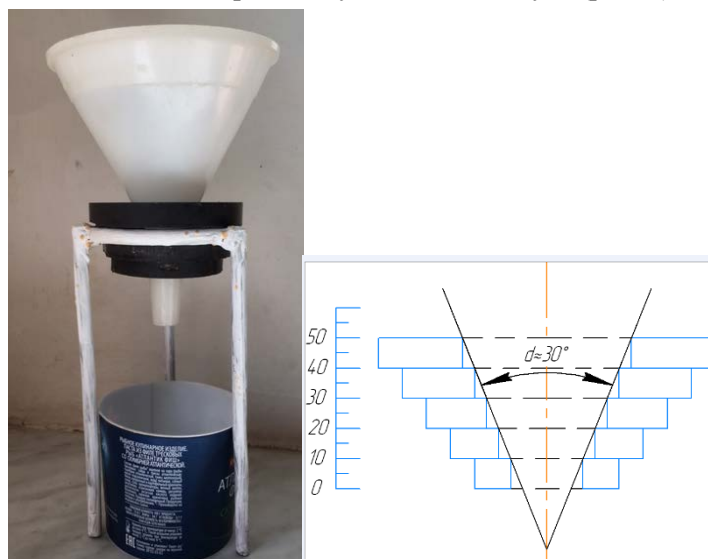
Рис. 1. Лабораторная установка для проведения экспериментов с магнитной обработкой зерна и схема расположения магнитов
