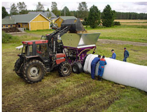
Рис. 26.8. Установки для плющения зерна «Murska»
