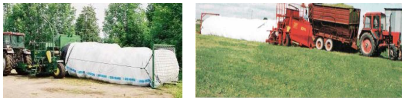
Рис. 26.7. Упаковщик сенажной и силосной массы в полимерный рукав УСМ-1
