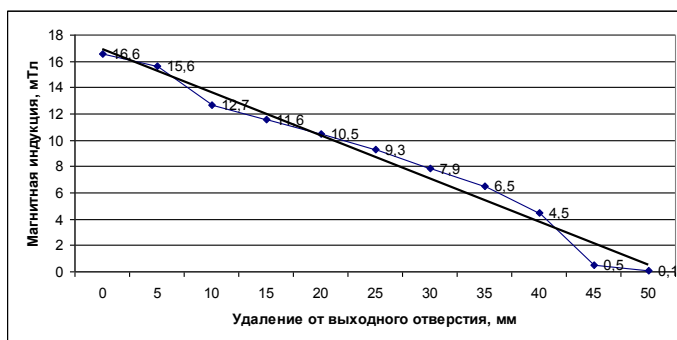
Рис. 2. Изменение нормальной составляющей магнитной индукции с удалением от выходного отверстия
