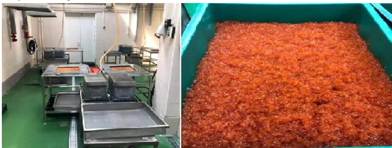
Рис. 2. Стол с двумя грохотками и пробитая соленая икра
