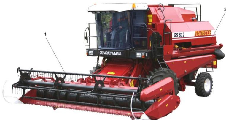
Рис. 12. Зерноуборочный комбайн ПАЛЕССЕ GS812:
