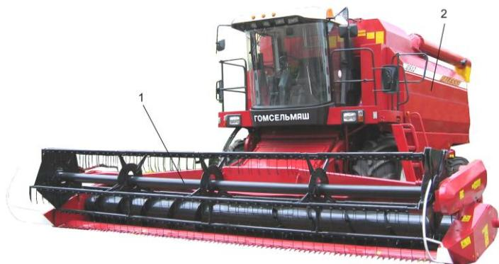
Рис. 9. Зерноуборочный комбайн ПАЛЕССЕ GS12:
