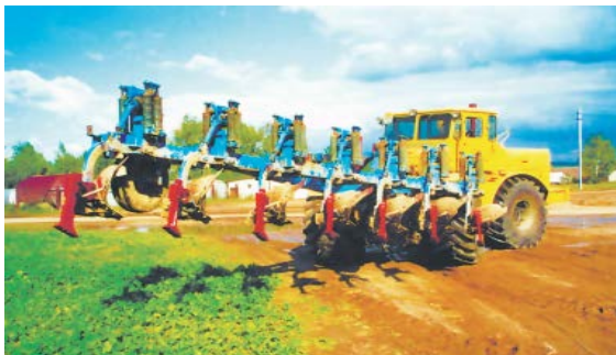
Рис. 9.1. Рыхлители плужной подошвы РПП-20 на плуге ППП-7-40 в агрегате с трактором К-701
