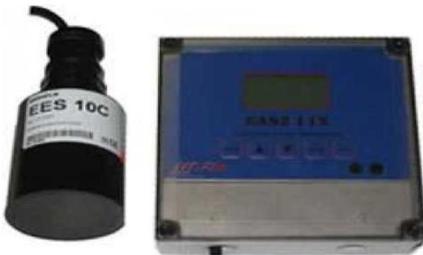
Рис. 1.37. Общий вид расходомера EASZ 11
