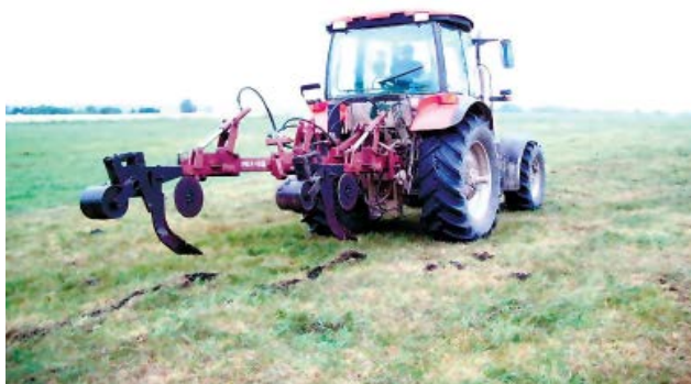
Рис. 9.2. Рыхлительное оборудование РКЛ-50 на базе рамы Плуга ПГП-3-40Б в агрегате с трактором МТЗ-1221
