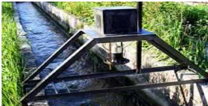
Рис. 1.35. Расходомер Sigma 950 на прямоугольном канале
