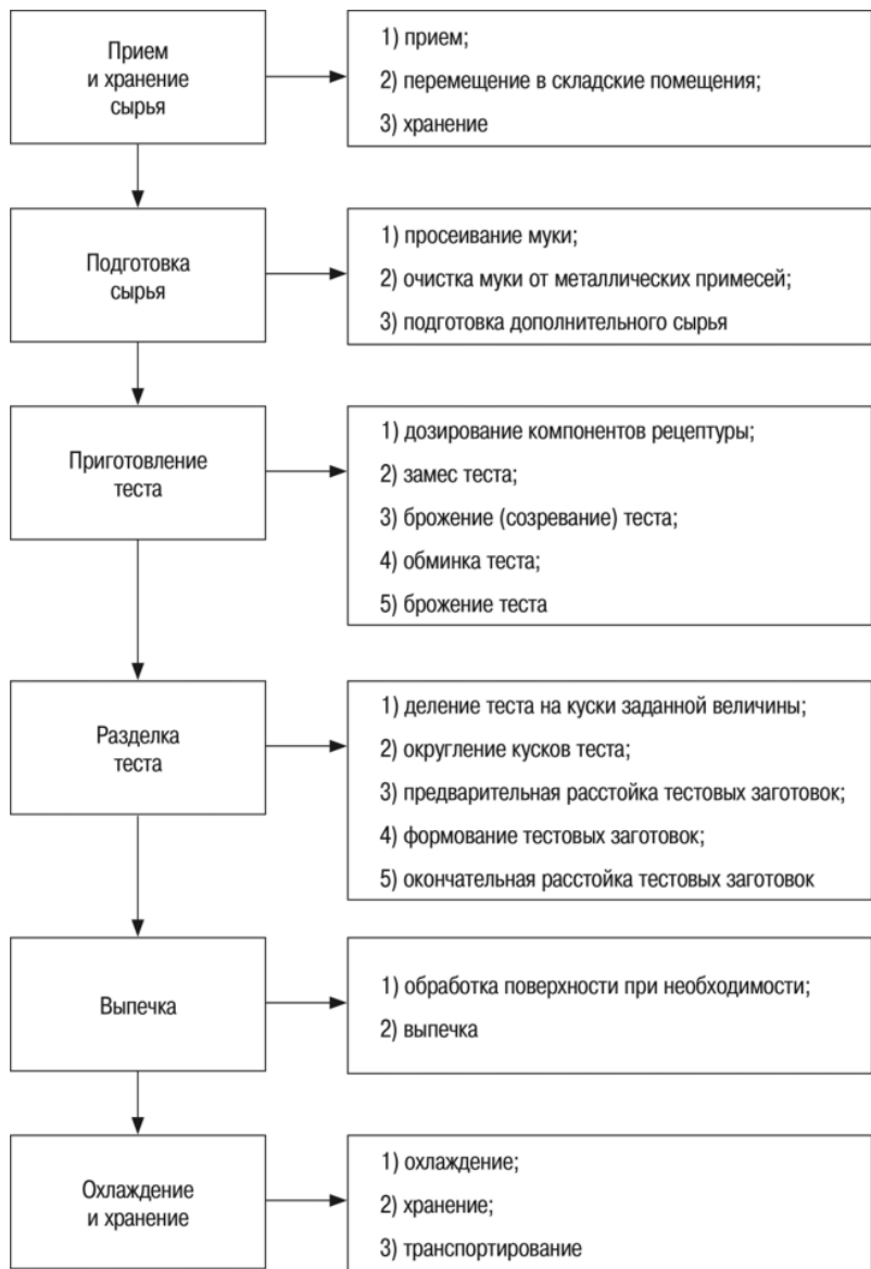
Рис. 2. Технологическая схема производства хлебулочных изделий
