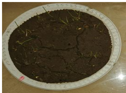
Рис. 3. Результаты опытов на лугово-серозёмном типе почвы с добавлением измельченной шелухи Tamarix, обработанной в электрическом импульсном разряде и посаженной пшеницей сорта Безостая-1, активированной в электрическом импульсном газовом разряде ( U=10 kv, t=3 min), полученные до и на 25-й день эксперимента
