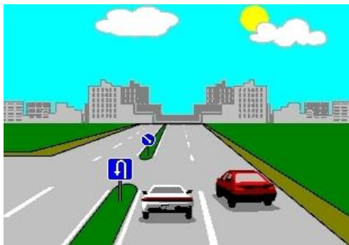
Рис. 1.58. Знак 5.11.1 «Место для разворота» применяется для обозначения разрывов в разделительной полосе, где организован разворот
