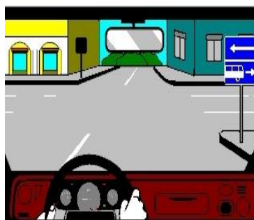
Рис. 1.57. Знак 5.10.3 «Выезд на дорогу с полосой для маршрутных транспортных средств». В данной ситуации водителю разрешено движение прямо, налево и на разворот, поворот направо запрещен, так как движение будет осуществляться по полосе для маршрутных транспортных средств
