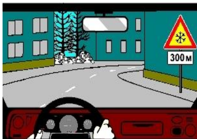
Рис. 1.68. Сочетание предупреждающего знака 1.33 и таблички 7.1.1 информирует водителя о том, что расстояние до участка дороги, на котором возможны снежные заносы либо ледяные или снежно-ледяные образования, 300 м
