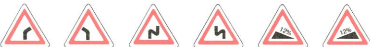
1.11.1 Опасный поворот 1.11.2 Опасные повороты 1.12.1 Опасные повороты 1.12.2 Опасные повороты 1.13 Крутой спуск 1.14 Крутой подъем
