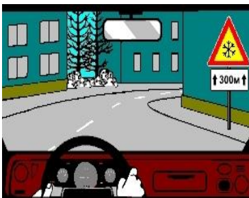
Рис. 1.72. Сочетание предупреждающего знака 1.33 и таблички 7.2.1 информирует водителя о том, что протяженность участка дороги, на котором возможны снежные заносы либо ледяные или снежно-ледяные образования, 300 м
