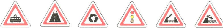
1.5 Пересечение с трамвайной линией 1.6 Конец дороги с усовершенствованным покрытием 1.7 Пересечение с круговым движением 1.8 Светофорное регулирование 1.9 Разводной мост или паромная переправа 1.10 Выезд на набережную
