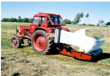
Рис. 14.1. Обмотчик рулонов ОР-1
