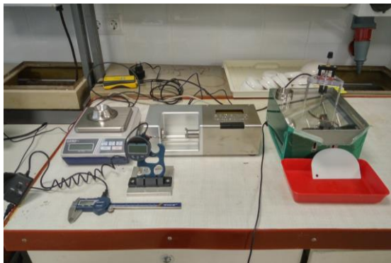
Рис. Комплекс приборов Broring informationstechnologie для определения морфологических качеств яиц с.-х. птицы
