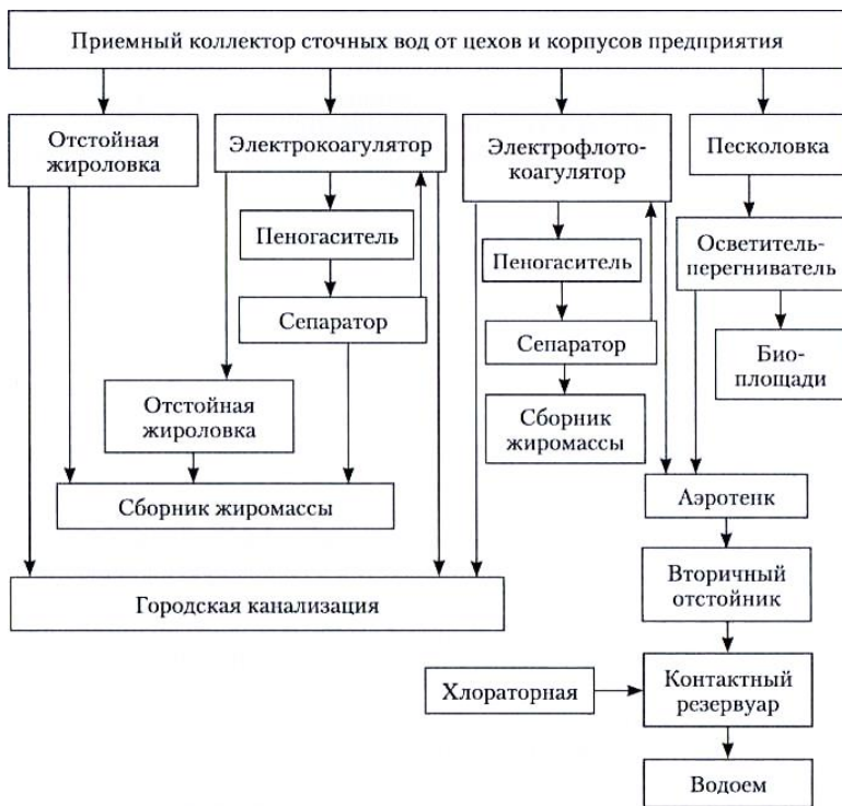
Рис. 7.6. Возможные схемы биологической очистки сточных вод молокоперерабатывающих предприятий
