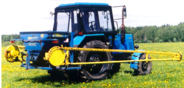
Рис. 8. Рассеиватель удобрений штанговый РШУ-12
