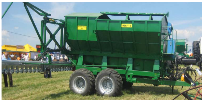
Рис. 9. Рассеиватель удобрений штанговый МШВУ-18
