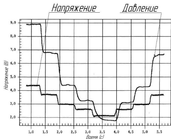
Рис. 4. Графики зависимости напряжения управления и давления во фрикционной муфте от времени при использовании наложения высокочастотной составляющей
