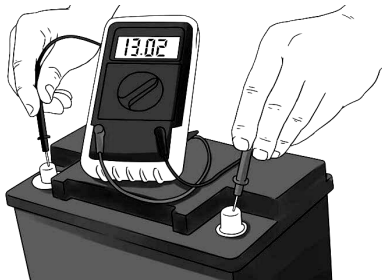
Рис. 2.66. Проверка аккумуляторной батареи мультиметром
