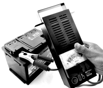
Рис. 2.67. Проверка аккумуляторной батареи анализатором состояния аккумуляторных батарей (нагрузочной вилкой)
