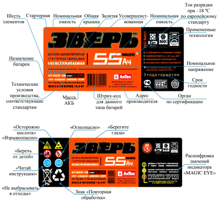
Рис. 2.62. Пример маркировки аккумуляторной батареи
