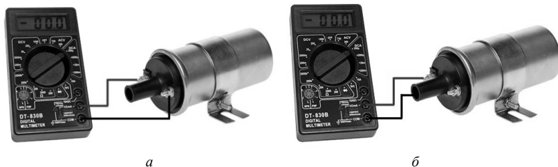
Рис. 2.77. Проверка исправности первичной (а) и вторичной (б) обмоток катушек зажигания замером их сопротивлений
