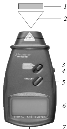
Рис. 2.74. Фототахометр DT6234В: 1 – отражающая метка; 2 – световой луч; 3 – кнопка «Измерение»; 4 – переключатель режима; 5 – кнопка «МЕМ»; 6 – дисплей; 7 – крышка отсека батареи
