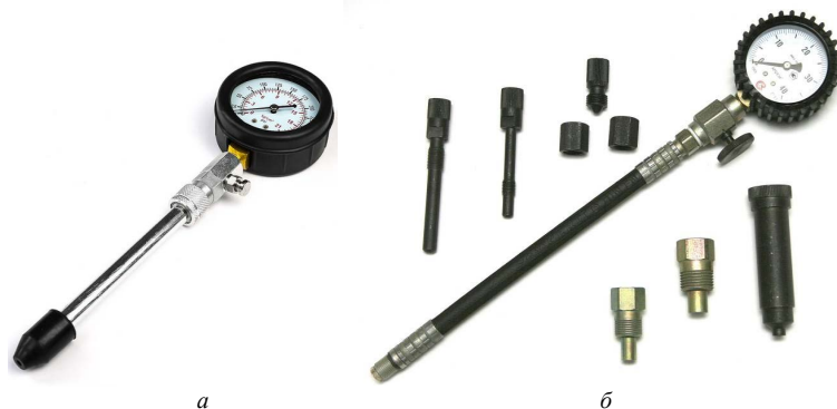
Рис. 2.4. Компрессометры: а – для бензиновых двигателей; б – для дизельных двигателей
