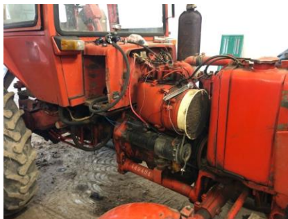
Рис. 3. Система впрыска воды на тракторе Т-25А
