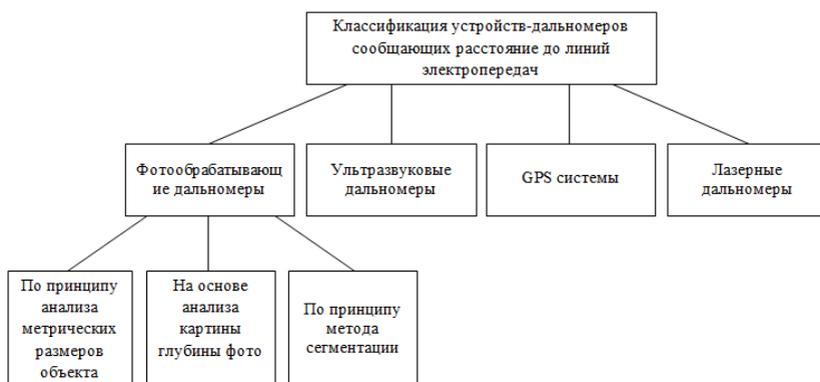
Рис. 1. Классификация устройств-дальномеров, сообщаящих расстояние до ЛЭП
