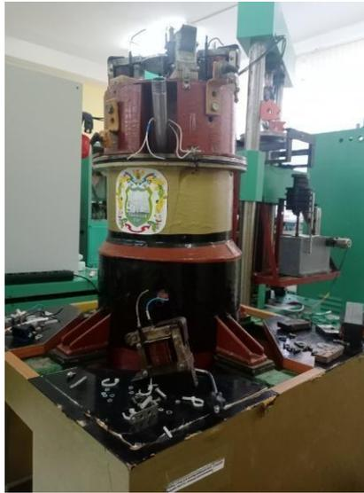
Рис. 1. Лабораторная установка с электромагнитным виброприводом
