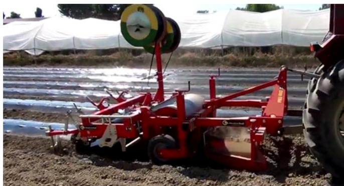
Рис. 3. Пленкоукладчик-грядообразователь AL-S14 PLUS
