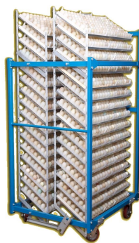
Рис. 46. Инкубатор предварительный ИП-36 «Эльбрус» (слева) и тележка с лотками (справа)
