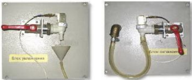
Рис. 45. Модернизация соленоидного клапана увлажнения (слева), охлаждения (справа)
