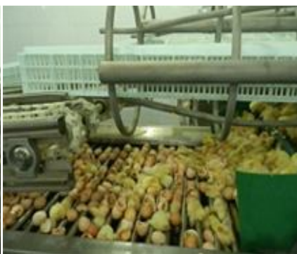
Рис. 135. Роликовый механизм сортировки
