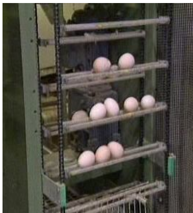
Рис. 80. Система яйцесборочного элеватора
