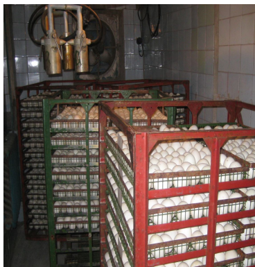
Рис. 147. Камера для аэрозольной обработки яиц формалином
