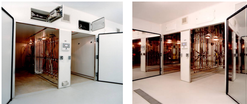
Рис. 62. Предварительный (слева) и выводной (справа) инкубаторы
