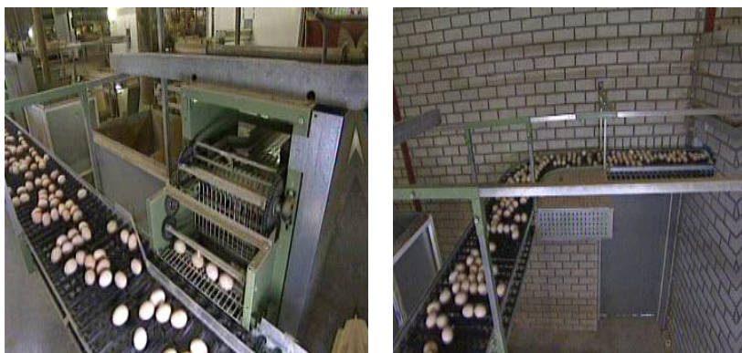
Рис. 81. Поперечный конвейер, идущий в яйцесборочный цех
