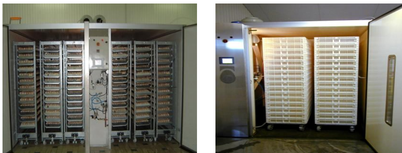
Рис. 56. Инкубационный (слева) и выводной (справа) шкафы ЕМКА-ПСМ серии VH
