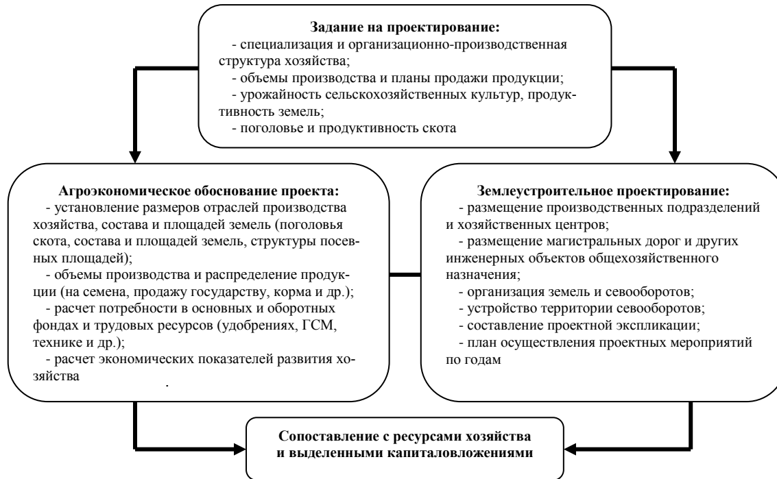
Рис. 3.1. Схема разработки проекта внутрихозяйственного землеустройства при традиционном методе проектирования
