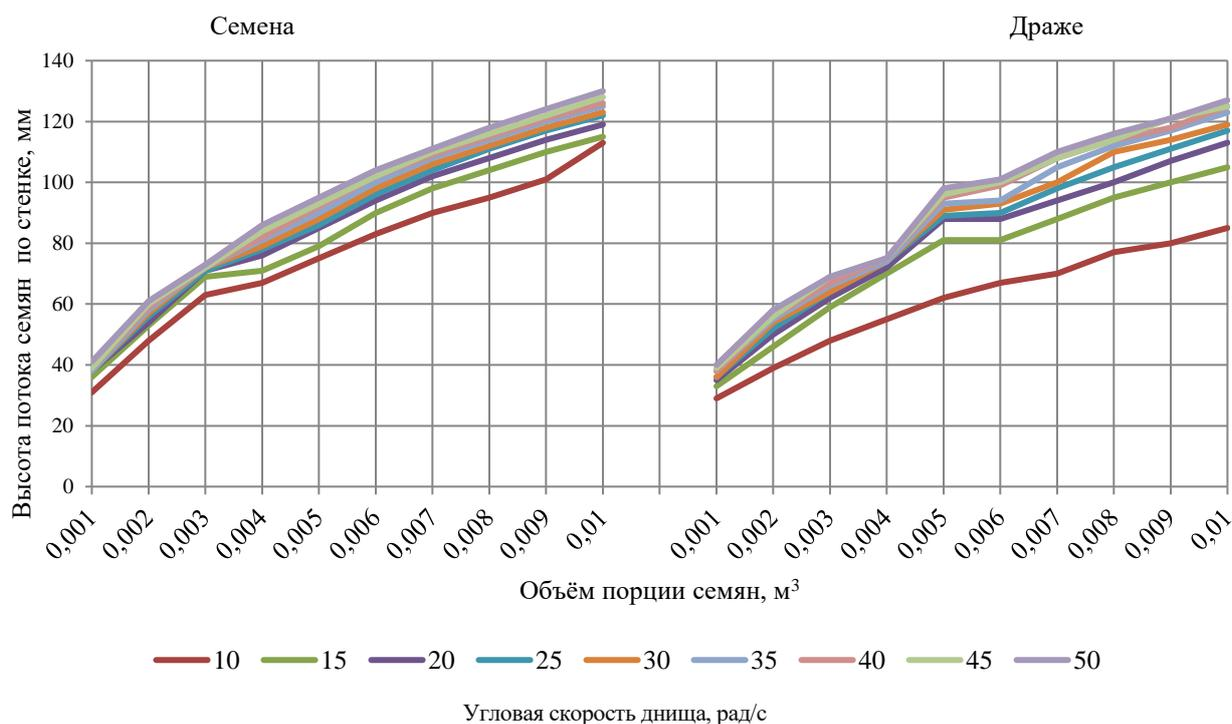
Рис. 3. График зависимости высоты подъёма семян по стенке камеры смешивания от загрузки и угловой скорости днища
