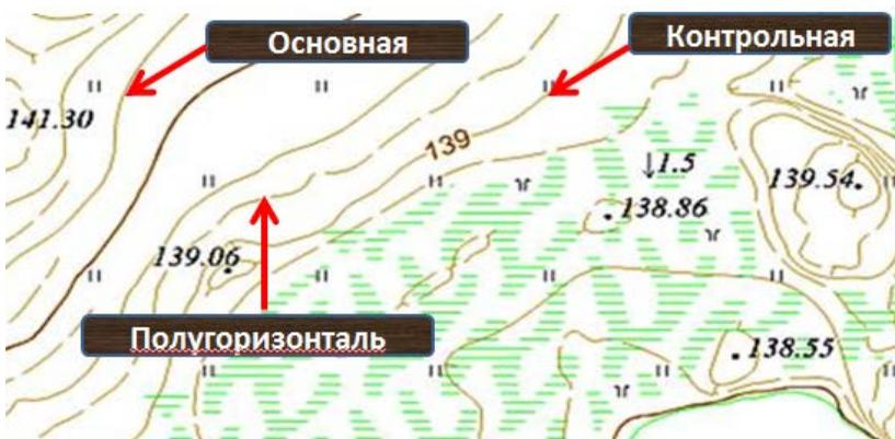
Рис. 20. Изображение рельефа с помощью горизонталей
