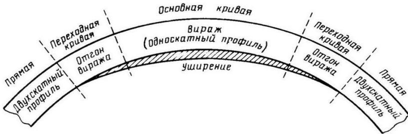
Рис. 3.12. Схема устройства закругления автомобильной дороги с виражом
