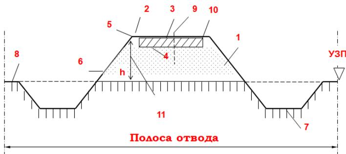
Рис. 4.11. Поперечный профиль в насыпи до 0,5 м: 1 – земляное полотно; 2 – обочина; 3 – проезжая часть; 4 – дорожная одежда; 5 – бровка земляного полотна насыпи; 6 – откос насыпи; 7 – кювет; 8 – обрез; 9 – ось проезжей части; 10 – кромка проезжей части; 11 – высота насыпи ( $h$ )
