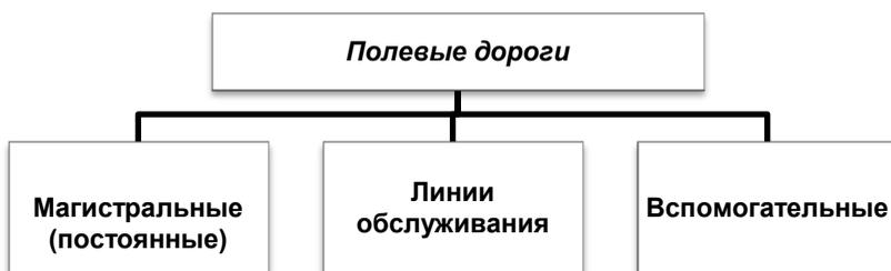
Рис. 2.4. Классификация полевых дорог
