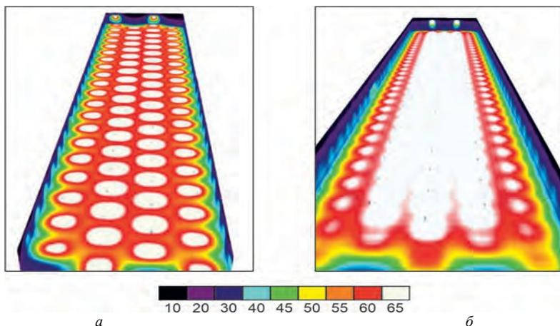
Рис. 5.2. Светотехнический расчет для птичника с напольным содержанием цыплят-бройлеров освещенностью 60 лк, оборудованного (на высоте 3 м) 84 светодиодными светильниками СН500-12-26-Г мощностью 12 Вт (а) и 165 светильниками СН300-6-13-Г 6 Вт (б) с 4 и 5 линиями освещения соответственно
