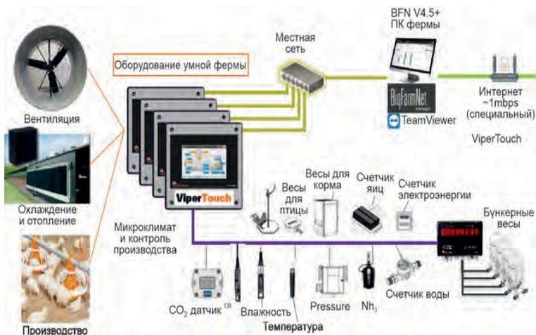
Рис. 1.2. Схема коммутации контроллера в птичнике
