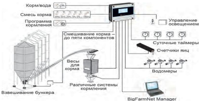
Рис. 2.1. Принципиальная схема управления системой кормораздачи в птичнике
