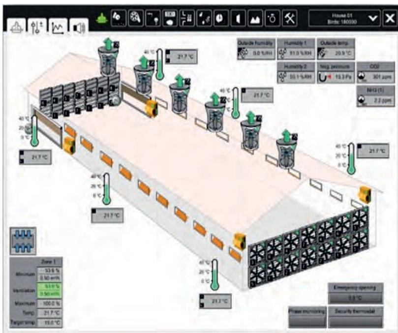
Рис. 1.3. Отображение элементов системы микроклимата в системе АМАКС
