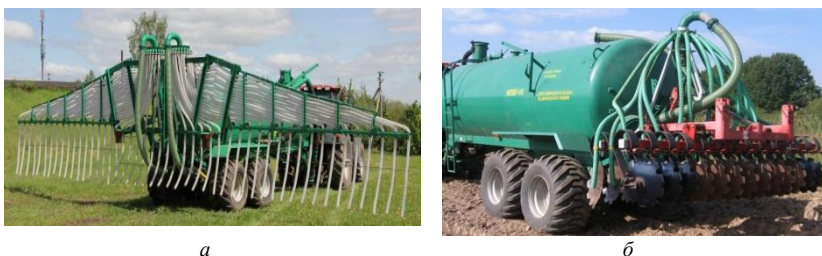
Рис. 7. Машина для внесения жидкого навоза МПВУ-16: а – с адаптером штанговым для поверхностного внесения жидкого навоза; б – с адаптером дисковым для внутрипочвенного внесения жидкого навоза
