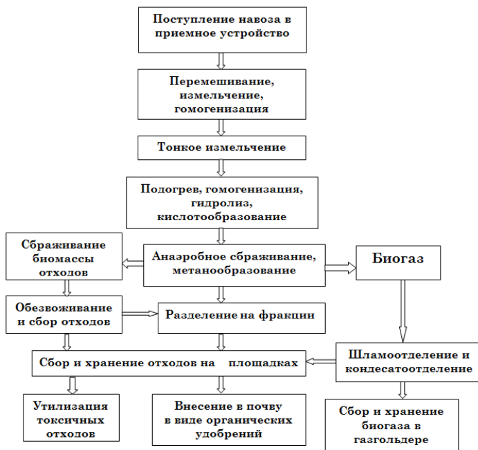
Рис. 1. Принципиальная пооперационная схема переработки навоза в биогаз
