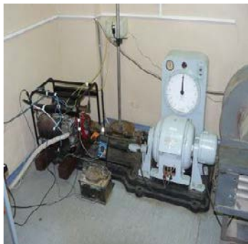
Рис. 1. Общий вид искрового двигателя и дизеля: а – искровой ДВС DDE UP168-1; б – дизель Д-245
