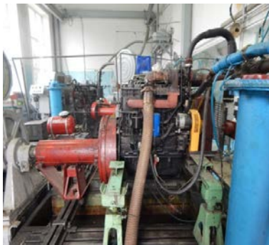
Рис. 1. Общий вид искрового двигателя и дизеля: а – искровой ДВС DDE UP168-1; б – дизель Д-245
