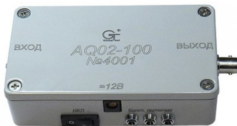
Рис. 2. Усилитель заряда AQ02-001
