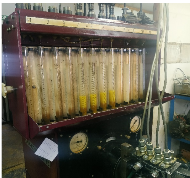
Рис. 1. Исследование многокомпонентного биотоплива на стенде КИ-22210-02М-11
