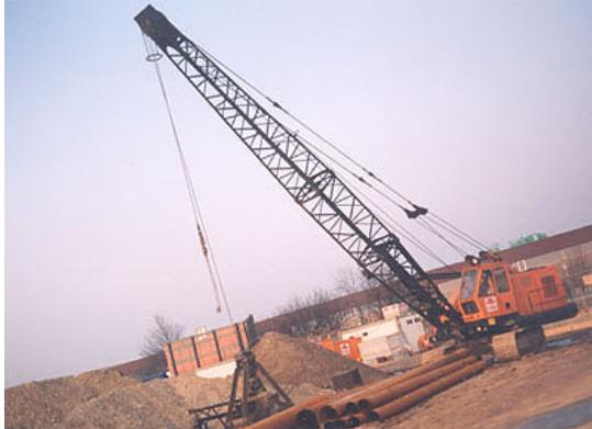
Als großer Bruder des UB 60 entstand der UB 80 mit einem Hochlöffel, einem Tieflöffel, einer Zugschaufel, einem Greifer und einem Kran. Neu sind auch das Pendelrollenlaufwerk, die pneumatische Steuerung und die vom Maschinenhaus getrennte Fahrerkabine.
