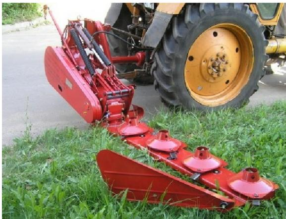
Das Rotationsmähwerk ist gelenkig mit dem äußeren Ausleger verbunden und kann mit Hilfe eines Hydraulikzylinders über Seilzug an die Böschungsneigung angepaßt werden. Zur Gewährleistung einer kontinuierlichen Arbeitsweise ist eine Abstützung mit Tandemstützrollen vorhanden. Die mögliche Arbeitsgeschwindigkeit beträgt 4,5 km/h.
