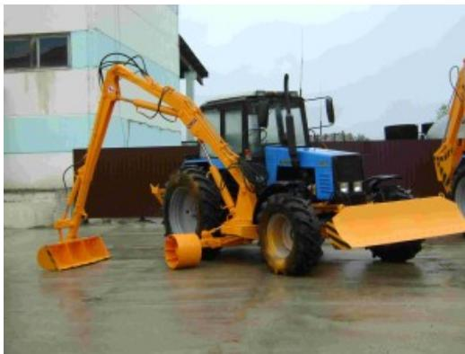
Die Instandhaltungsmaschine kann in diskontinuierlicher und kontinuierlicher Arbeitsweise mit den entsprechenden Anbaugeräten eingesetzt werden. Zur Gewährleistung kontinuierlicher Arbeitsweise ist eine Abstützung mit Tandemstützrollen vorhanden.
