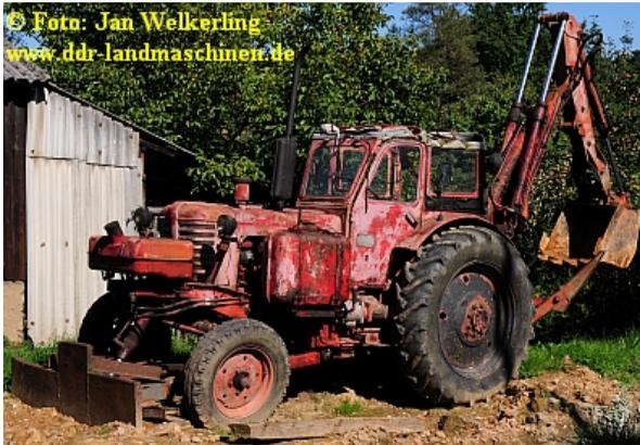
Der E-1514 hat ein mechanisches 5-Gang-Schaltgetriebe mit einem Zwischengetriebe und einem sperrbarem Differentialgetriebe, womit der Schlepper auf der Straße eine Geschwindigkeit von 22,2 km/h erreicht.
