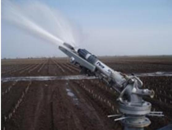
*Drehstahlregnern*. Die Drehstahlregner sind gebräuchlichste Type. Die Wasserverteilung erfolgt radial durch Drehung des Strahlrohres.
