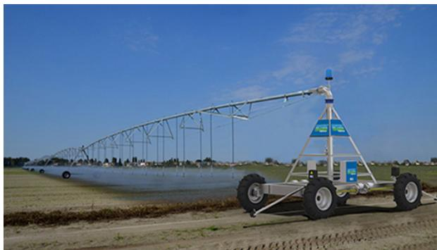
Die Maschine kann das Wasser aus Hydranten entnehmen. Außerdem können zwei Maschinen DMA-200 gekoppelt werden und nebeneinander arbeiten, so dass eine Arbeitsbreite von 250 m erreicht wird. Für den Einsatz dieser Beregnungsmaschinen sind ein relativ dichtes Graben- oder Rohrnetz und sehr lange sowie absolut ebene Flächen erforderlich.
