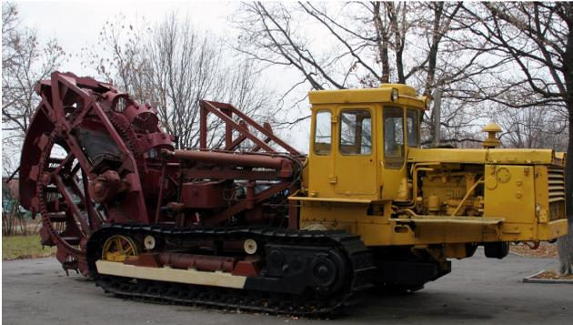
Der Fräsrad-Grabenbagger dient vornehmlich zur Herstellung der Saugergräben bei der Tonrohrdränung auf schweren und steinigen Böden.
