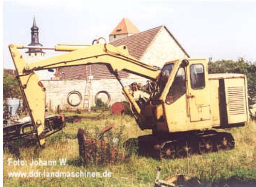
*Der Bagger* der 60-iger und 70-iger Jahre war der Universalbagger 80 von NOBAS Nordhausen. Der Universalbagger 80 hat fast 30 Jahre seine Dienste getan. Der Fahrmechanismus ist so ausgelegt, dass der Bagger bei einer Geschwindigkeit von 1,4 km/h, Steigungen von 1:5 und bei der Beladung auf Lastkraftwagen bis 1:3,5 befahren werden kann. Die Hydraulikanlage wird von einer Pumpe mit 75 l/min und 125 atm versorgt. Der Bagger zeichnet sich durch hochwertige Materialien aus.
