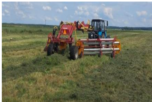
Рис. 11. Грабли-валкователи гребенчатые ГВГ-9,5
