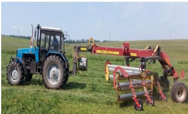
Рис. 11. Грабли-валкователи гребенчатые ГВГ-9,5
