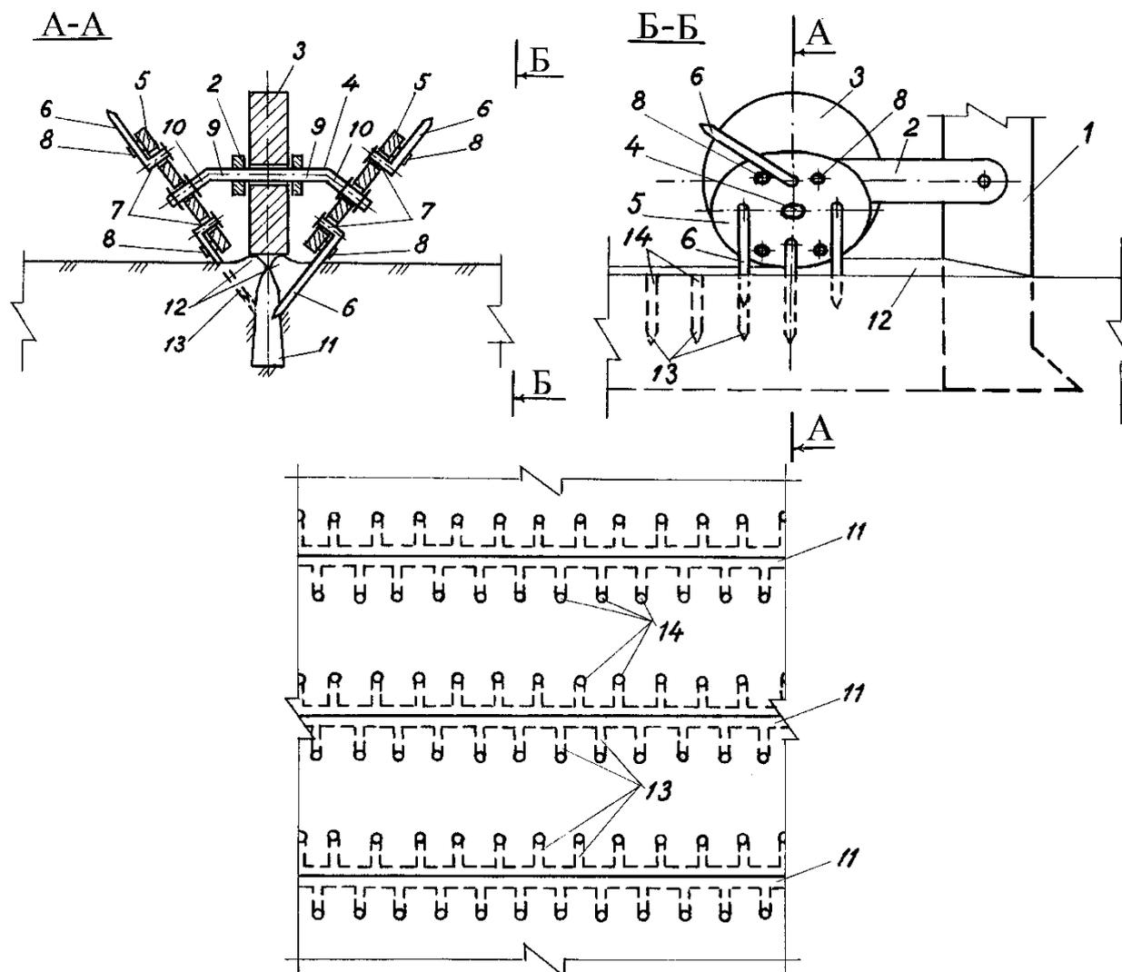
Рис. 2. Принципиальная схема устройства для обработки поверхности поля [6]: 1 – рабочий орган щелереза; 2 – кронштейн; 3 – прикатывающий каток; 4 – ось катка; 5 – штифтовый диск; 6 – штифт; 7 – шарнир; 8 – ограничитель; 9 – оси вращения прикатывающего катка; 10 – ось вращения штифтовых дисков; 11 – щель в почве; 12 – почвенный валик; 13 – вертикальные отверстия в почве
