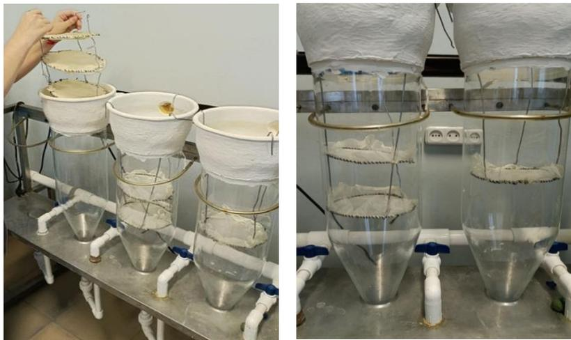
Рис. 1. Размещение сетчатых площадок в аппаратах Вейса
