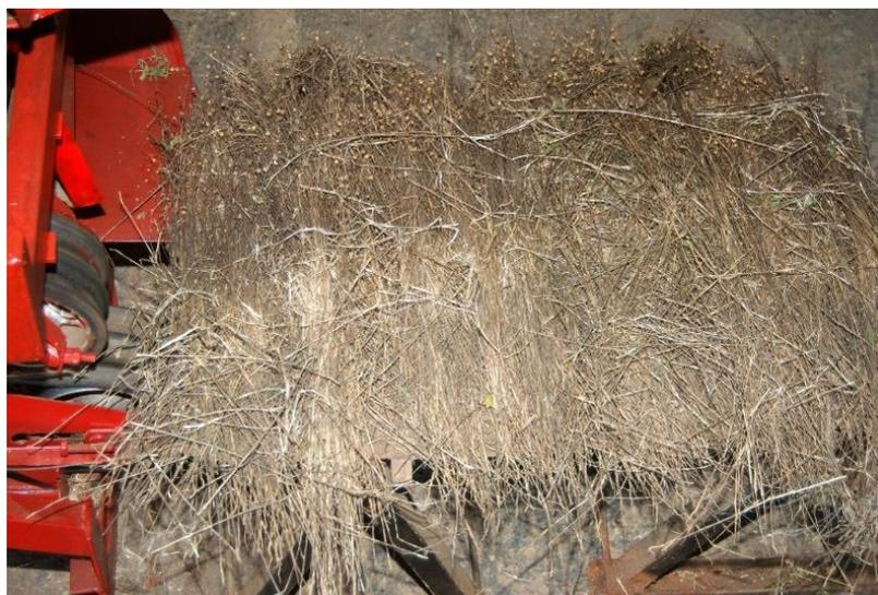
Рис. 3.11. Общий вид уложенной на подающий транспортер ленты
