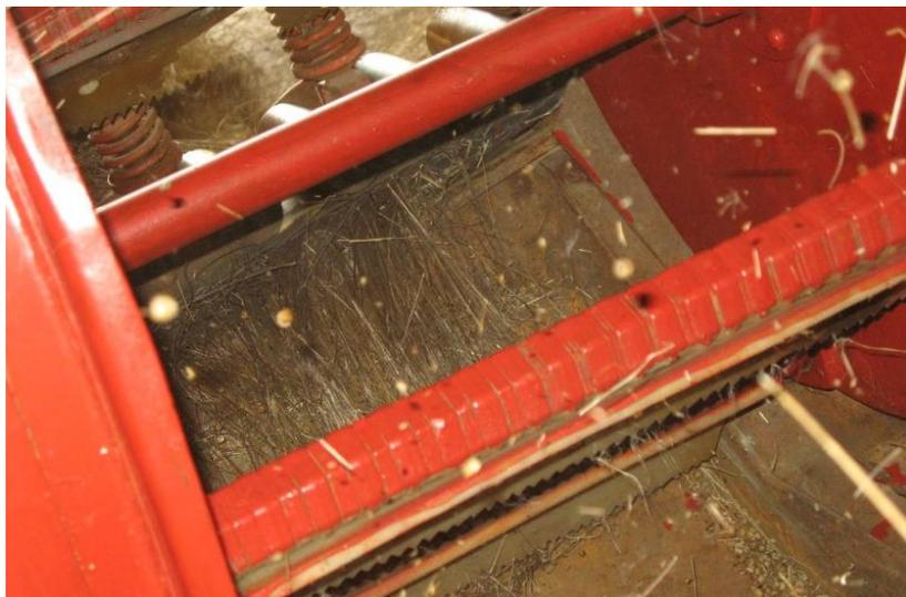
Рис. 3.12. Общий вид камеры в процессе обмолота ленты льнотресты
