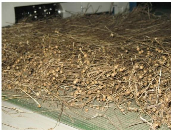
Рис. 5.1. Общий вид поступающей на обмолот ленты льнотресты
