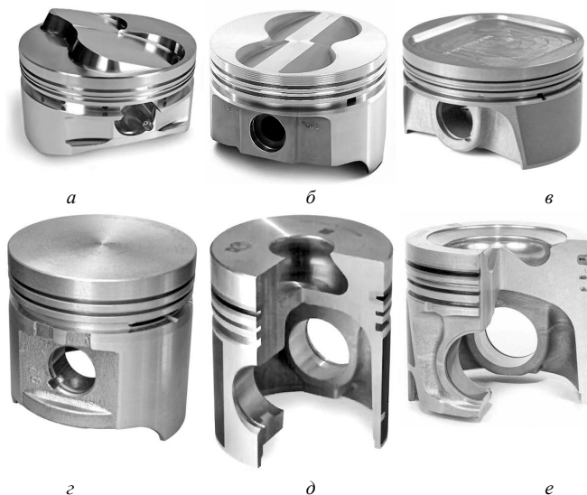
Рис. 3.6. Форма днища поршней: а – с вытеснителем и выемками для клапанов; б – с плоским днищем и выемками для клапанов; в – с углубленным днищем; г – с плоским днищем; д – с трапециевидной камерой сгорания; е – с тороидальной камерой сгорания
