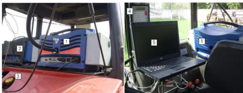
Рис. 3.20. Приборы для замера экологических показателей, смонтированные на тракторе «Беларус-922»: 1 – дымомер MDO 2 LON ; 2 – газоанализатор MGT 5 ; 3 – топливозаправочная горловина трактора «Беларус-922»; 4 – пульт управления дымомером; 5 – ноутбук с программным обеспечением
