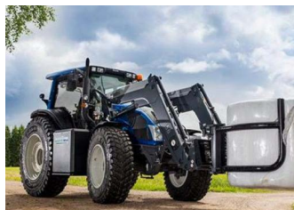
Рис. 1.27. Трактор Valtra Dual Fuel с системой подачи КПП и ДТ
