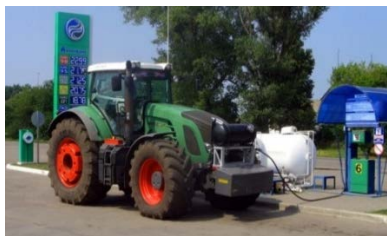
Рис. 1.26. Трактор Fendt 824 Vario с системой подачи газа
