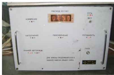
Рис. 3.8. Электронный расходомер топлива АИР-50 с весовым устройством: а – пульт управления электронным расходомером топлива; б – весовое устройство расходомера топлива
