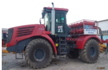
Рис. 1.24. Опытный образец трактора Кировец К7 с системой подачи КПП
