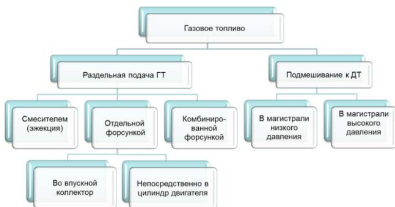
Рис. 1.12. Классификация систем питания дизелей газовым топливом [110]
