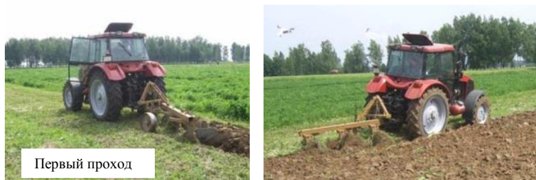
Рис. 3.22. Работа МТА «Беларус-922» + ПЛН-3-35 при работе на ДГТ
