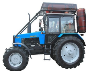
Рис. 1.23. Трактор «Беларус-1221.2» с системой подачи КПП и ДТ
