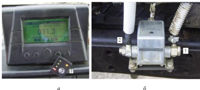
Рис. 3.18. Расходомер дизельного топлива:
