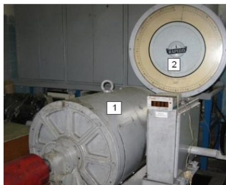
Рис. 3.3. Электротормозной стенд SAK-N670 с балансирующей маятниковой машиной RAPIDO (Германия): 1 – электрический двигатель; 2 – весовой механизм
