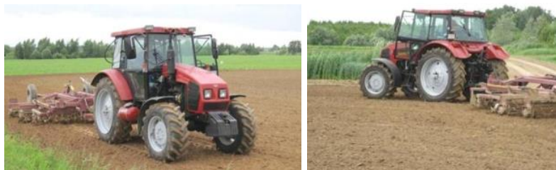
Рис. 3.23. Работа МТА «Беларус-922» + АКШ-3,6-01 при работе на ДГТ
