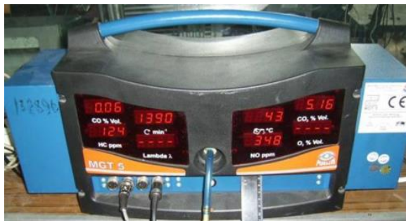
Рис. 3.7. Газоанализатор МАНА MGT-5 (Германия)
