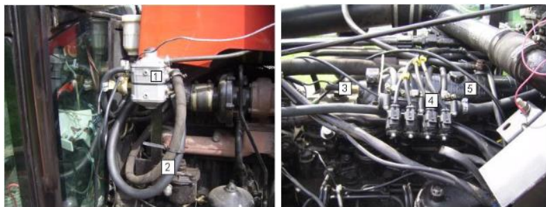
Рис. 3.17. Элементы газовой системы питания, смонтированной на колесном тракторе «Беларус-922»:
