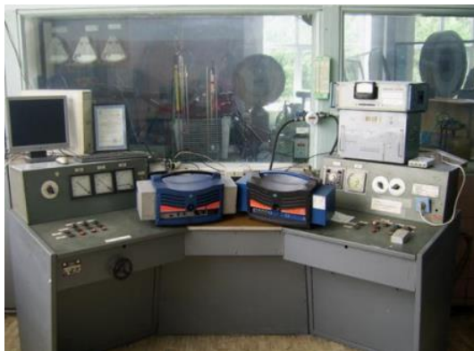
Рис. 3.4. Пульт управления экспериментальной установкой для испытания двигателей внутреннего сгорания
