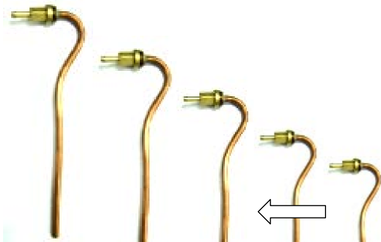
Рис. 4.15. Впускной коллектор дизеля Д-245.5 и удлинители для подачи газового топлива: a – впускной коллектор; б – удлинители
