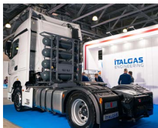
Рис. 1.29. Магистральный тягач КАМАЗ М1945 с газодизельной си- стемой подачи топлива
