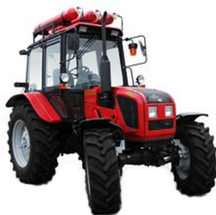
Рис. 1.21. Трактор «Беларус-92П» с системой подачи КПП и ДТ
