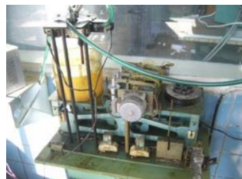
Рис. 3.8. Электронный расходомер топлива АИР-50 с весовым устройством: а – пульт управления электронным расходомером топлива; б – весовое устройство расходомера топлива
