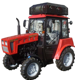
Рис. 1.20. Трактор «Беларус-320.4М» с системой подачи КПП и ДТ
