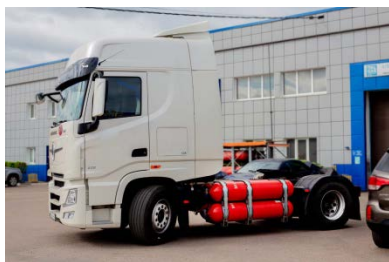
Рис. 1.28. Магистральный тягач DONGFENG DFH4180 с газодизельной системой подачи топлива
