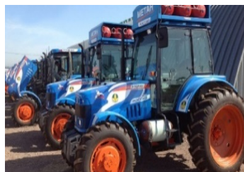
Рис. 1.25. Трактор АГРОМАШ 85ТК МЕТАН с системой подачи КПП
