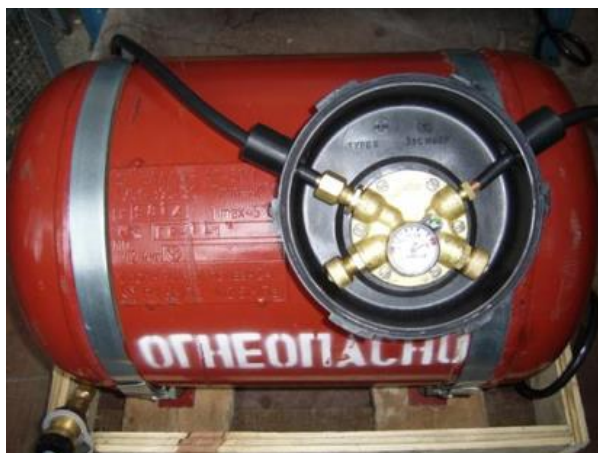
Рис. 3.11. Вид газового баллона АГ-30/1, применявшегося на испытаниях
