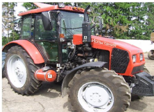
Рис. 3.16. Трактор «Беларус-922» с системой подачи газа: 1 – газовый баллон; 2 – выносное заправочное устройство; 3 – газовый редуктор; 4 – датчик температуры отработавших газов
