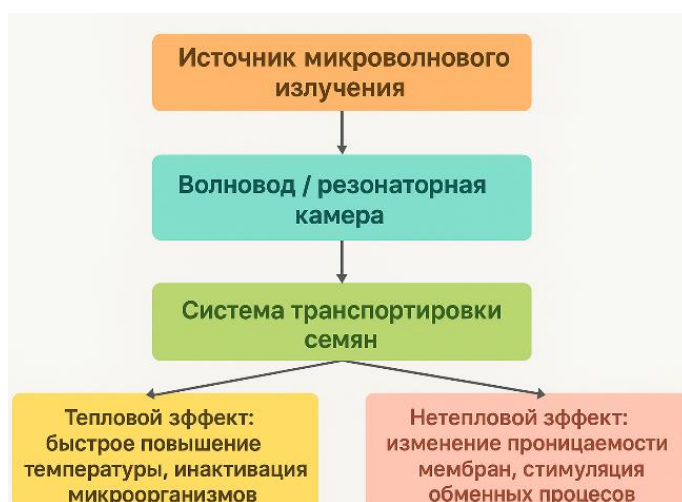
Рис. 2. Схематическое представление механизма действия микроволновой предпосевной обработки
